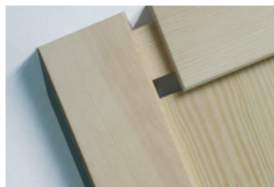
Assemblage par tenon et mortaise
