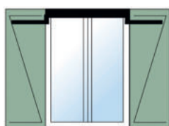
Sous linteau (fixation haute)
