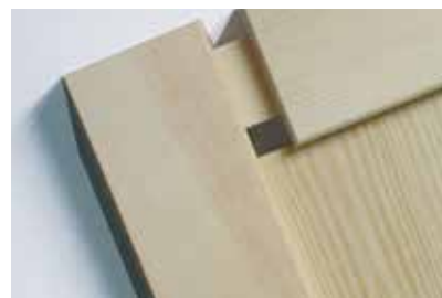
Assemblage par tenon et mortaise
