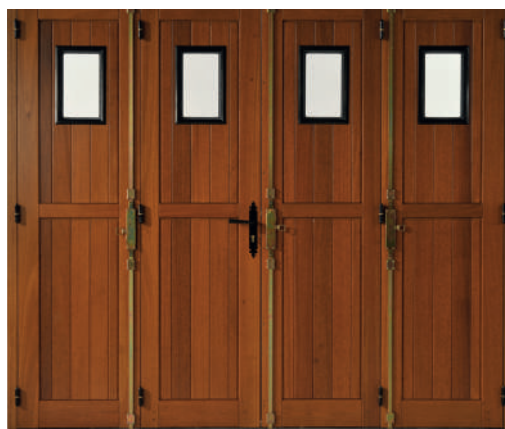
4 vantaux Exotique : cadre de 32 mm , panneaux frises verticales ép. 27 mm , hublots PVC, serrure 3 points, bâti de 65 x 55 mm
