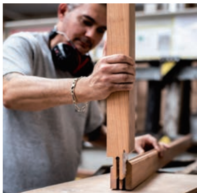
Assemblage traditionnel des ouvrants en double enfourchement
