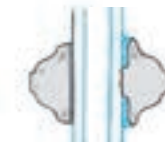
doucine (intérieur et extérieur) intérieur ◀ ▶ extérieur
