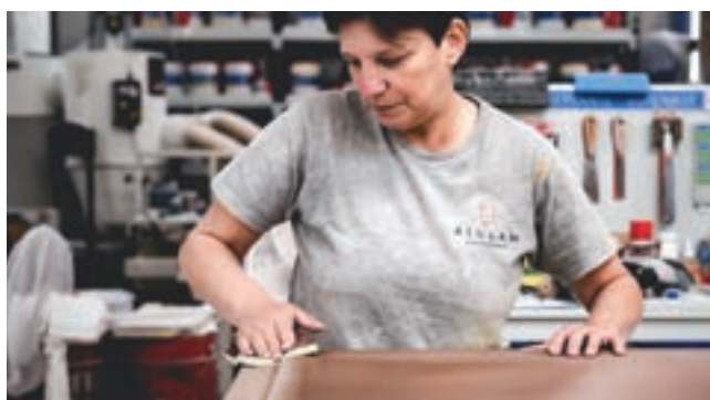
Chaque fenêtre est ensuite egrainée à la main pour une finition de haute qualité
