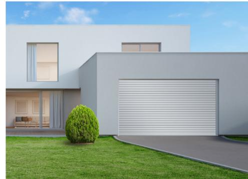
Composée de **lames en aluminium** qui s'enroulent sur un **axe** et viennent se loger au plafond, dans un coffre situé au-dessus de l'ouverture du garage.
