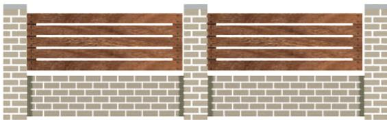
· Lames horizontales largeur entre 125 mm et 150 mm, épaisseur 15 mm avec ajourage de 25 mm
